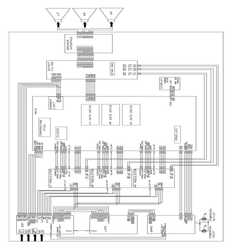
FIG. 5 DRIVEPACK BLOCK DIAGRAM
