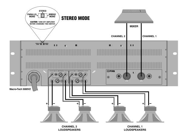
Fig. 3.4 Stereo Wiring
